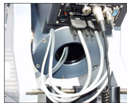
GM 4000 Kontrollpaneel und Kabelzuführung an der Stundenachse
